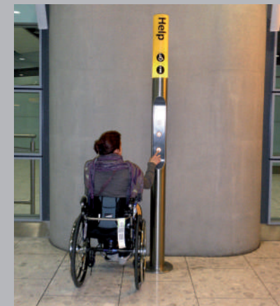
✅ Borne d'appel avec bouton-poussoir à bonne hauteur
