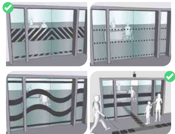
Sécurisation d'une porte vitrée avec des bandes de couleurs contrastées
